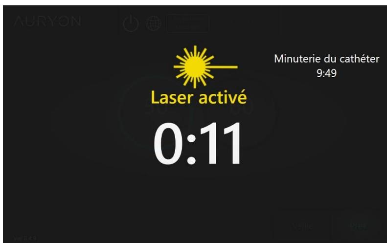
Pendant ce temps, une LED horizontale de couleur jaune sur la console clignotera et un bip sonore sera émis pour avertir que le laser est actif. L'activation du laser s'arrêtera dès que la pédale de commande sera relâchée. L'écran de sélection du niveau d'énergie avec le système laser est toujours en mode « Prêt » et le mode de fonctionnement de la pompe apparaîtra alors à nouveau.
