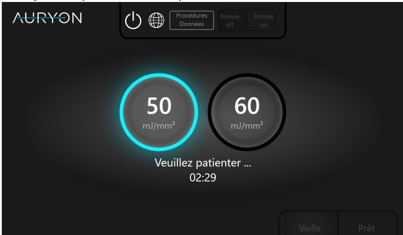
Une fois que le compte à rebours s'est écoulé, le système est prêt à être utilisé et l'écran suivant apparaîtra sur le panneau de commande tactile :
